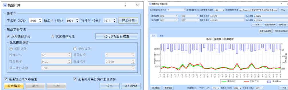
(7) 不退出“模型校验-水量过程”窗口，进行第2个水文断面的参数调参，以此类推，直至完成。
