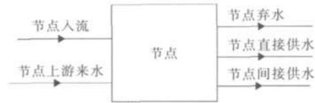
图4 节点水量平衡概化
